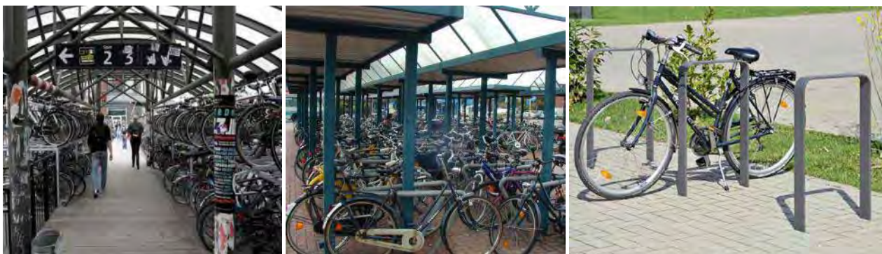
Abb. 39: links und Mitte: Fahrradabstellanlage mit hoher Kapazität (Typ 3); rechtes Foto: Fahrradabstellanlage mit niedriger Kapazität (Typ 4).
