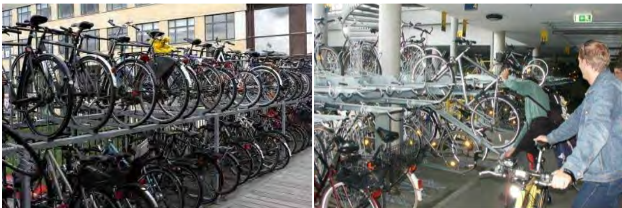
Abb. 41: Für Fahrradgaragen und Radstationen sind Systeme zum Übereinanderparken geeignet, um eine hohe Kapazität zu erreichen.
